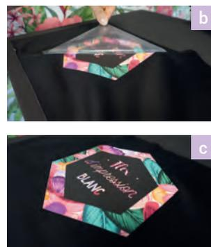
Placez le flex<sup>(a)</sup> et pressez le tout à la température et au temps indiqués. Retirez ensuite le film de transfert<sup>(b)</sup>, à chaud ou à froid (selon la fiche technique). C'est prêt<sup>(c)</sup> !
