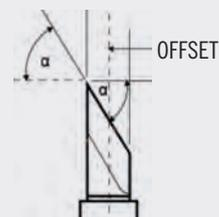
L'offset décrit la distance entre l'axe central de la lame et la pointe de la lame. Il détermine le rayon de rotation de la lame et la façon dont elle compense la distance lors des pivotements dans les angles.
