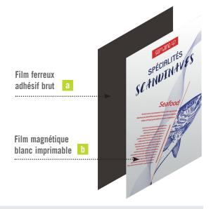
Le film ferreux adhésif vous permet de créer une surface ferreuse réceptive aux aimants et éléments magnétiques.
